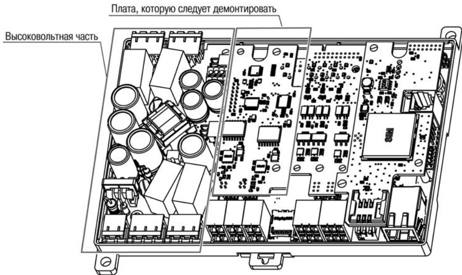
Рисунок Е.6 – Расположение зоны с высоковольтной частью и платой, закрывающей доступ к джамперу XP6
