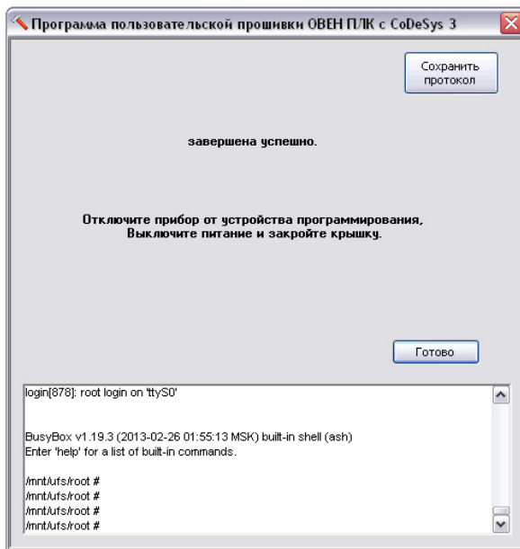
Рисунок Е.5 – Окно программы после успешного завершения процесса смены встроенного ПО ПЛК
