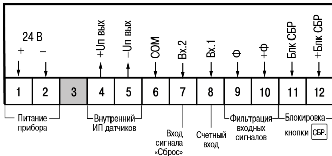
Рисунок 5.1 – Назначение контактов клеммника
