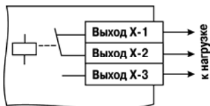
Рисунок Б.1 – Схема подключения нагрузки к ВУ типа Р
