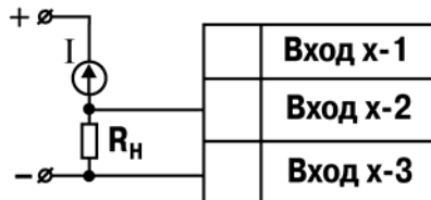
Рисунок Б.10 – Схема подключения термоэлектрического преобразователя
