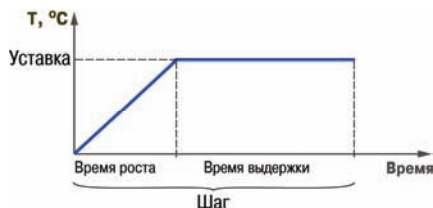
Рис. 3.12. Схема шага Программы технолога
