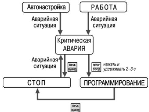
Рис. 8.2.Схема переключения режимов при Критической АВАРИИ
