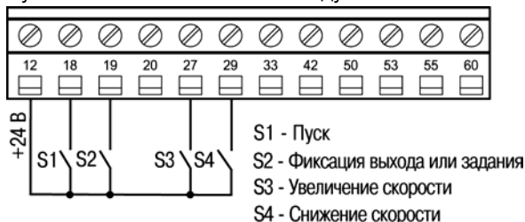
Рисунок 4.4 – Схема подключений для конфигурации «Работа на трех предустановленных скоростях»
