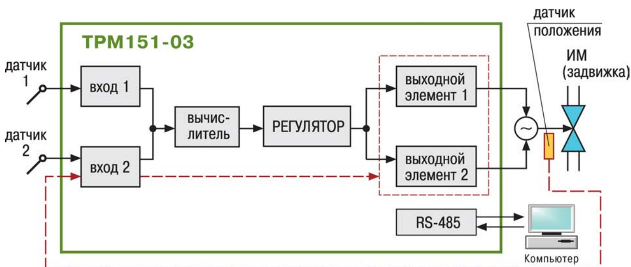
Рисунок 4.3 – Принципиальная схема модификации 03 прибора TPM151
