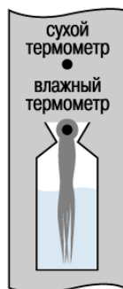
Рисунок Л.3 – Форма резервуара с «бутылочным горлом»
