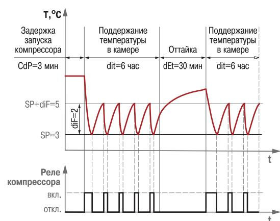
▲ Пример работы TPM961 в режиме ТЕРМОСТАТ: график изменения температуры в камере и временная диаграмма работы реле компрессора (для значений параметров, установленных по умолчанию на заводе-изготовителе)
