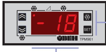
**3-х разрядный цифровой индикатор** в режиме ТЕРМОСТАТ используется для вывода измеренного значения температуры и диагностических сообщений.
