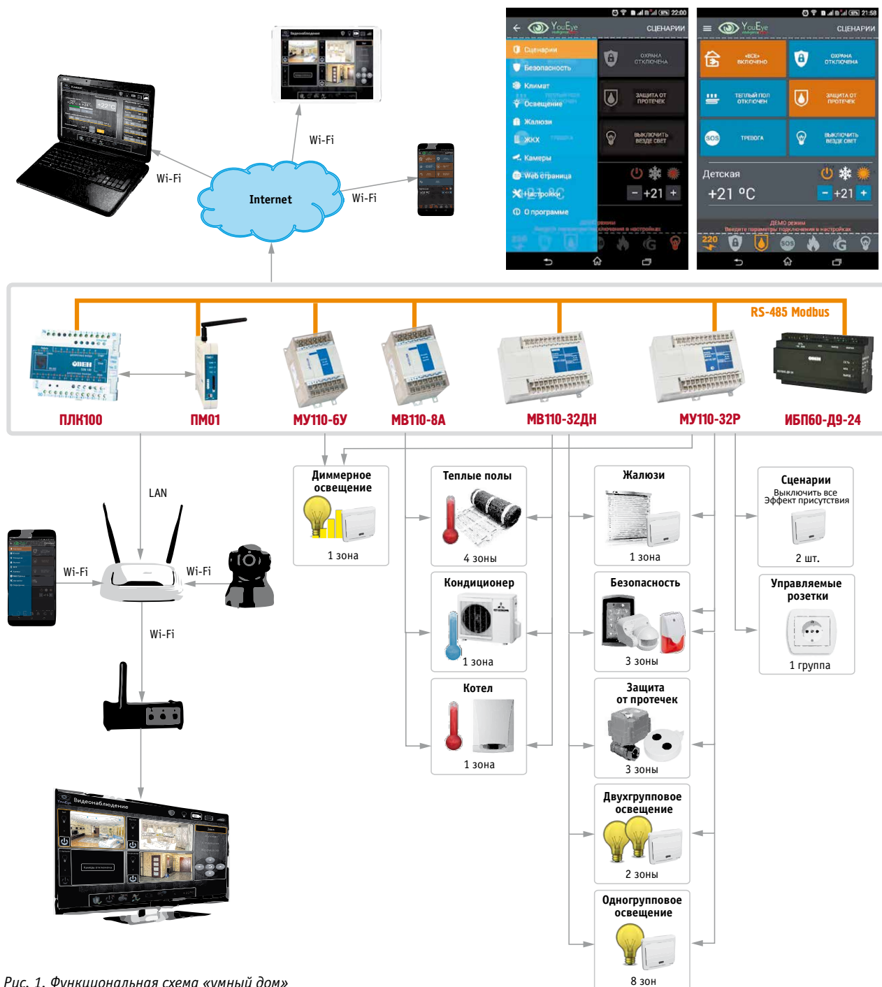
Рис. 1. Функциональная схема «умный дом»
