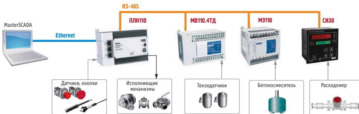
Рис. 1. Функциональная схема управления бетономесительным комплексом
