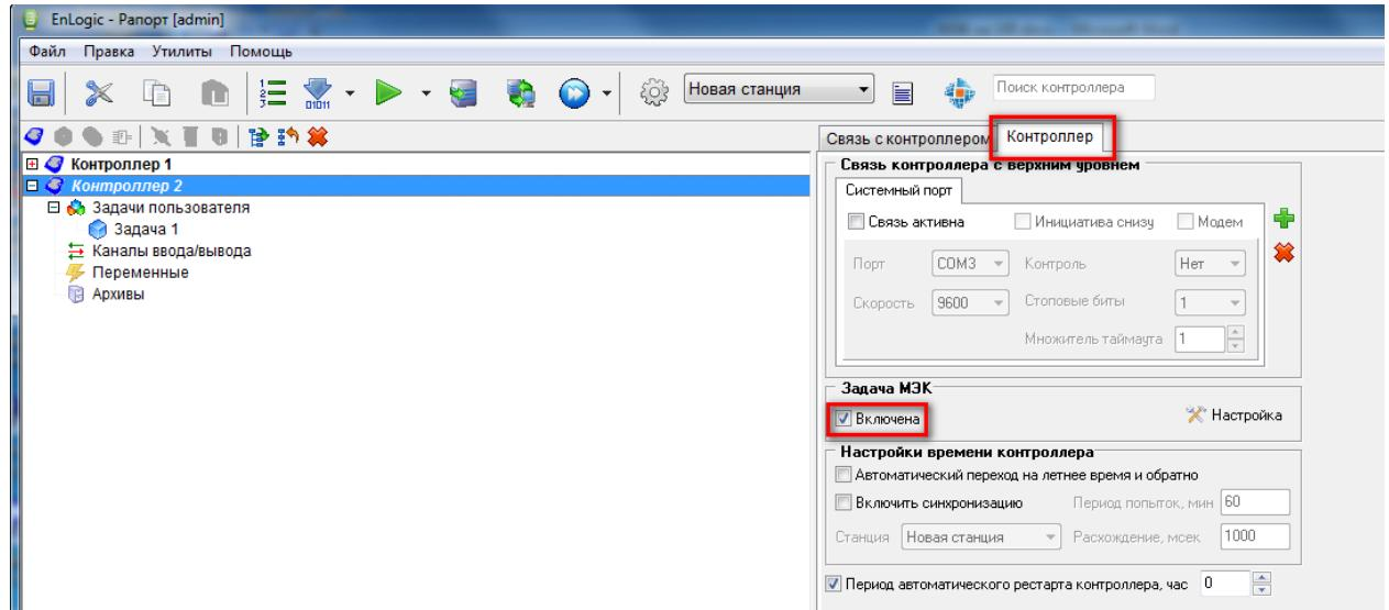
Для передачи данных в МЭК-104 на верхний уровень с дополнительных устройств нужно открыть «Карту адресов конфигурации»:
