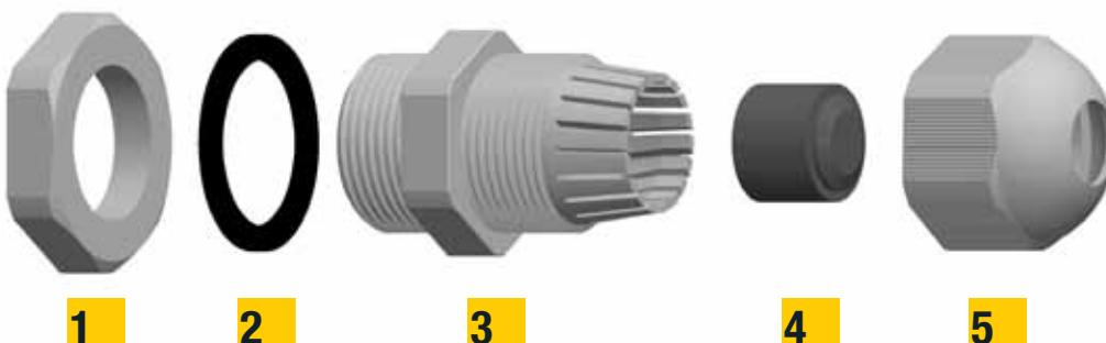
Кабельный ввод PG состоит из фиксирующей гайки 1, уплотнительного кольца 2, корпуса сальника 3, уплотнительного элемента с защитной мембраной 4, гайки уплотнения 5
