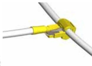
Ответвитель защелкивается на основном проводе. При этом его контактная часть из луженой латуни прорезает изоляцию провода.
