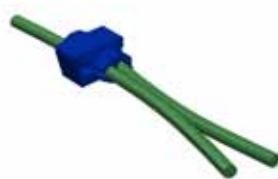
Закрепить ответвитель на отводящем проводе.
