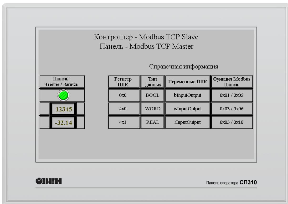
Рис. 42. Ввод значений с помощью сенсорного дисплея панели
