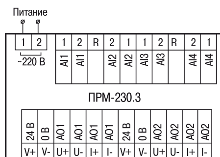
Рисунок 5.3 – Назначение контактов клеммника прибора с питанием 230 В
