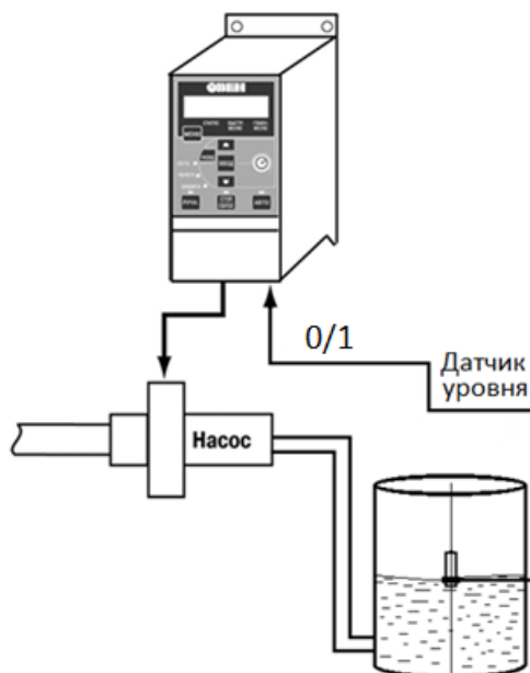
Рисунок 1, Схема системы с поддержанием уровня в ёмкости.
