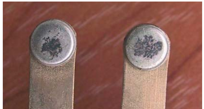
Рис. 2. Вид контактов электромагнитного реле, проработавшего некоторое время
