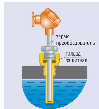
Рис. 4. Установка датчика температуры с использованием защитной гильзы
