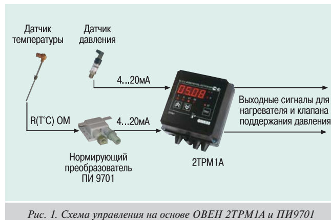
Рис. 1. Схема управления на основе ОВЕН 2ТРМ1А и ПИ9701
