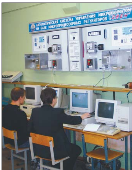
Рис. 1. Учебный лабораторный стенд «Автоматическая система управления микроклиматом на базе микропроцессорных регуляторов ОВЕН»
