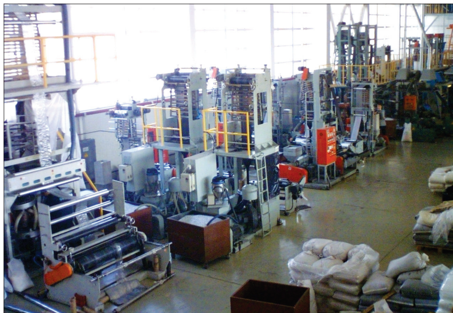
Фото 1. Экструдеры на участке производства пленки
