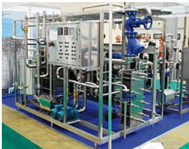
Фото 2. Станция приемки, учета и охлаждения ООО «СЛАВУТИЧ»
