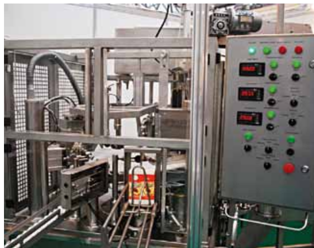
Фото 3. Автомат для разлива жидких и вязких продуктов ООО «ВИЯ»
