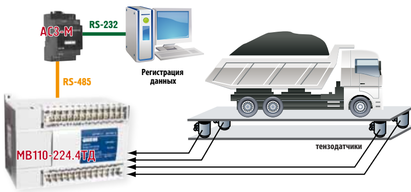
Рис. 1. Пример применения модуля MB110-224.4ТД
