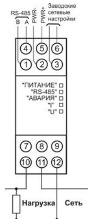
Рисунок Б.1 – Подключение прибора к однофазной сети
