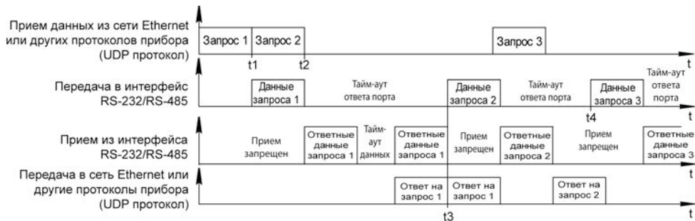
Рисунок 4.6 – Диаграмма работы прибора в режиме «запрос – ответ»
