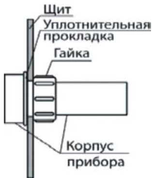
Рисунок 5.2 – Монтаж прибора ИНС-Ф1.Х.Щ9 в щит
