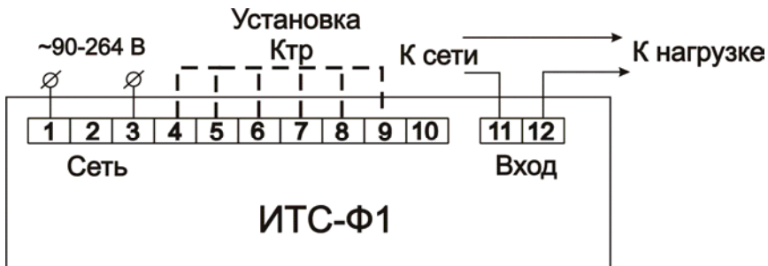
Рисунок Б.1 – Схема подключения прибора
