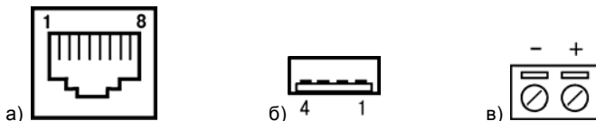
Рисунок 3.2 – Вид разъемов: Ethernet порт (а), разъем USB (б), разъем питания (в)
