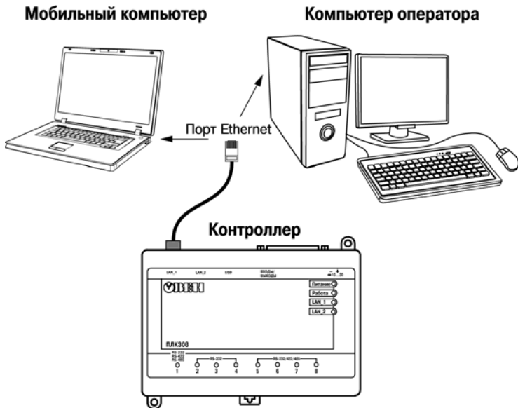
Рисунок 4.1 – Вариант подключения к ПК для программирования контроллера через порт Ethernet
