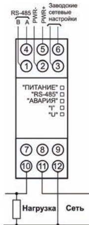
Рисунок Б.1 – Подключение прибора к однофазной сети
