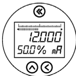
Рисунок 3.3 – Лицевая панель вычислительного блока
