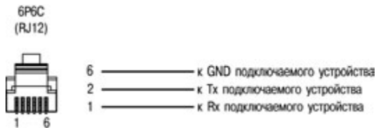
Рисунок В.4 - Схема кабеля для подключения к порту Debug RS-232
