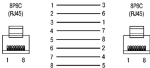
Рисунок В.7 – Кабель Ethernet crossover
