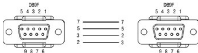
Рисунок В.6 – Кабель KC4 для подключения ПЛК150 к панелям ИП320, СП270 и СП3хх (порт RS-232 Download)
