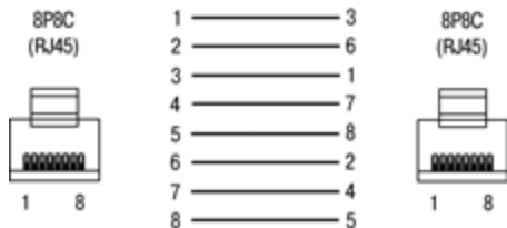
Рисунок В.7 – Кабель Ethernet crossover
